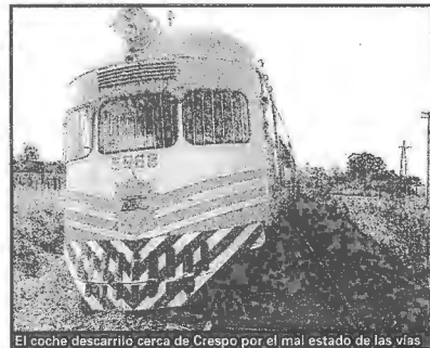
El coche descarriló cerca de Crespo por el mal estado de las vías
