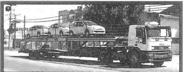
1) Semirremolque portavehículos, únicos con una longitud de 22,40 metros. 2) Para contenedores y cargas generales, un semi playo. 3) Acoplado cerealero. 4) Bitrenes, tecnología aún en experimentación. 5) Clásico furgón para cargas secas o congeladas. 6) Interior de un furgón de fibra de vidrio. 7) Semirremolque de barandas bajas.
