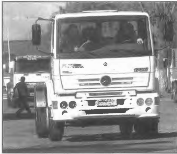
Una gran calidad de este Mercedes-Benz 1728 es su baja tara. En condiciones de marcha pesa 5350 kilogramos, lo que le otorga ventajas frente a los modelos pesados del segmento de los 300 CV. Este ahorro se traduce, obviamente, en una mayor capacidad de carga útil.
