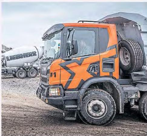
de descanso; se le adicionó un gancho delantero de remolque de hasta 40 toneladas; paragolpes delanteros de 150 mm de espesor en una pieza, y un escalón lateral con pasamanos para facilitar el control de la carga.
