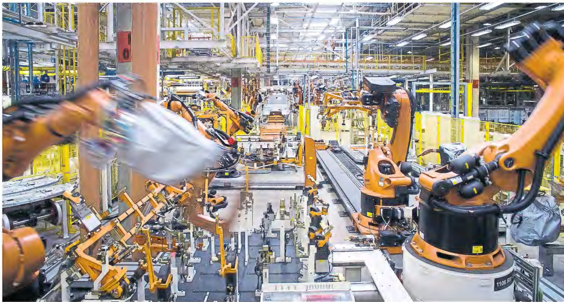
Los robots automatizan gran parte del armado de las cabinas en la planta ubicada en Resende, Brasil
